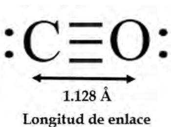
**Figura 1.1** Estructura electrónica del monóxido de carbono.
